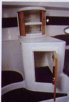
Sopra, il blocco con il mobile bar realizzato in controstampo in vetroresina con portelli curvi di legno.
